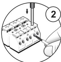
Натиснути викруткою на кнопку колодки і вставити дрот в контактний отвір до упору. Між колодкою та ізоляцією дроту не повинно залишатися оголеного дроту.
