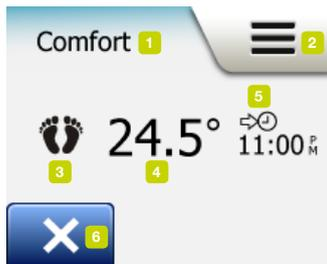
Во время работы термостата в режиме Комфорта на Исходном дисплее отображается кнопка “X”. Нажмите эту кнопку для возврата термостата в автоматический режим работы по установленному графику.
