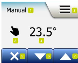
В ручном режиме существует возможность деактивировать работу термостата по установленному графику и поддерживать какое-то время специально заданную температуру.
