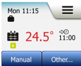
Вы можете отменить режим Отпуск и возвратиться в автоматический режим работы по установленному графику нажав кнопку “X”.
